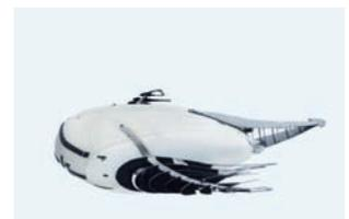
Bei Aqua\_ray erzeugt, gleich einem Herz, eine wasserbetriebene zentrale Flügelszellenpumpe die erforderliche Energie, die in Form von Druck über eigens dafür entwickelte Spezialventile an drei antagonistisch arbeitende Muskelpaare weitergegeben wird. Deren Zugkraft wird durch künstliche Sehnen aus hochfesten Seilen über Rollen und Sehnnenscheiden auf die Flügel und den Schwanz übertragen, welche den Kraftweg von 55 mm zu einem Flügelschlag von mehr als 550 mm nutzen.
