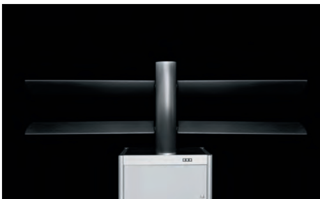
Neuartiges Konzept: gegenläufige Flügelpaare mit linearer Hubbewegung ...
