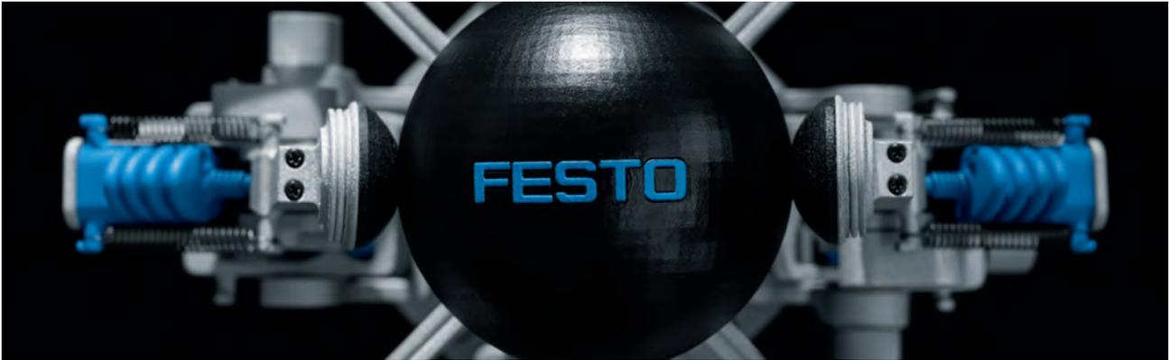
Der LearningGripper von Festo entspricht in abstrahierter Weise der menschlichen Hand. Die vier Finger des Greifers werden von zwölf pneumatischen Balgaktoren mit Niederdruck angetrieben. Mittels Machine-Learning-Verfahren ist er in der Lage, eine komplexe Handlung wie das Greifen und Orientieren eines Gegenstands selbst zu erlernen.
