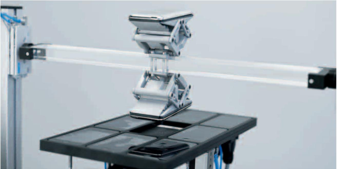
**Greifen und Ablegen im Wechsel:** zwei NanoForceGripper im Rotationsprinzip
