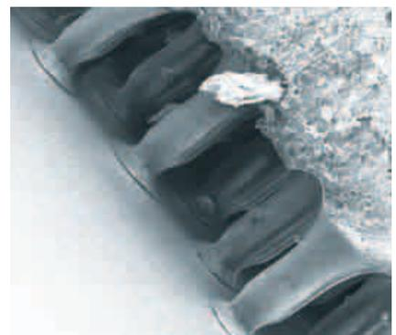
**Der Greifer unterm Mikroskop:** die Nanostruktur der Folie 400-mal vergrößert
