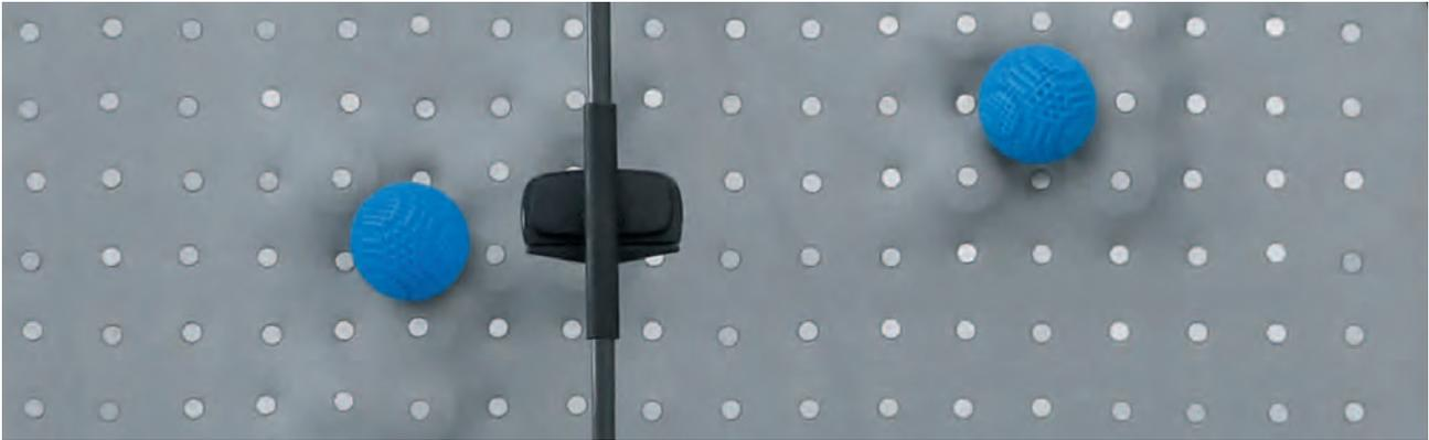
Das WaveHandling von Festo ist ein pneumatisches Förderband, das Gegenstände gezielt transportieren und gleichzeitig sortieren kann. Eine Vielzahl von Balgmodulen verformt dabei die Oberfläche so, dass die Objekte durch eine Wellenbewegung zielgerichtet befördert werden.
