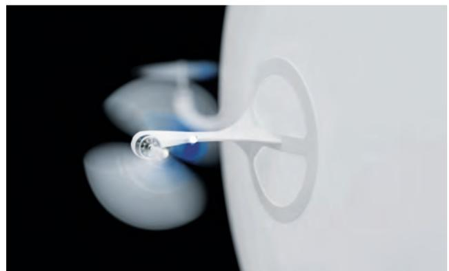
**Vertikale Propeller:** horizontales Fliegen, Beschleunigen und Abbremsen
