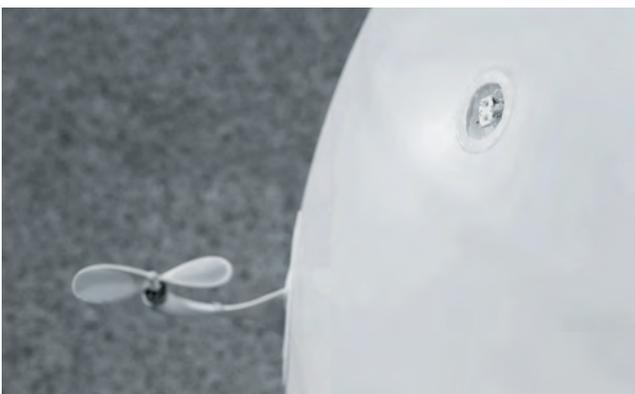
**Aktive Marker:** Infrarot-LEDs zur Kommunikation mit den Kameras
